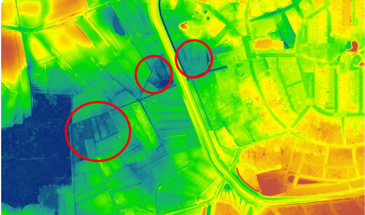
Figuur 23 Potentiële retentielocaties voor opvang van clusterbuien. Normaal bevoeid voor natuurontwikkeling
