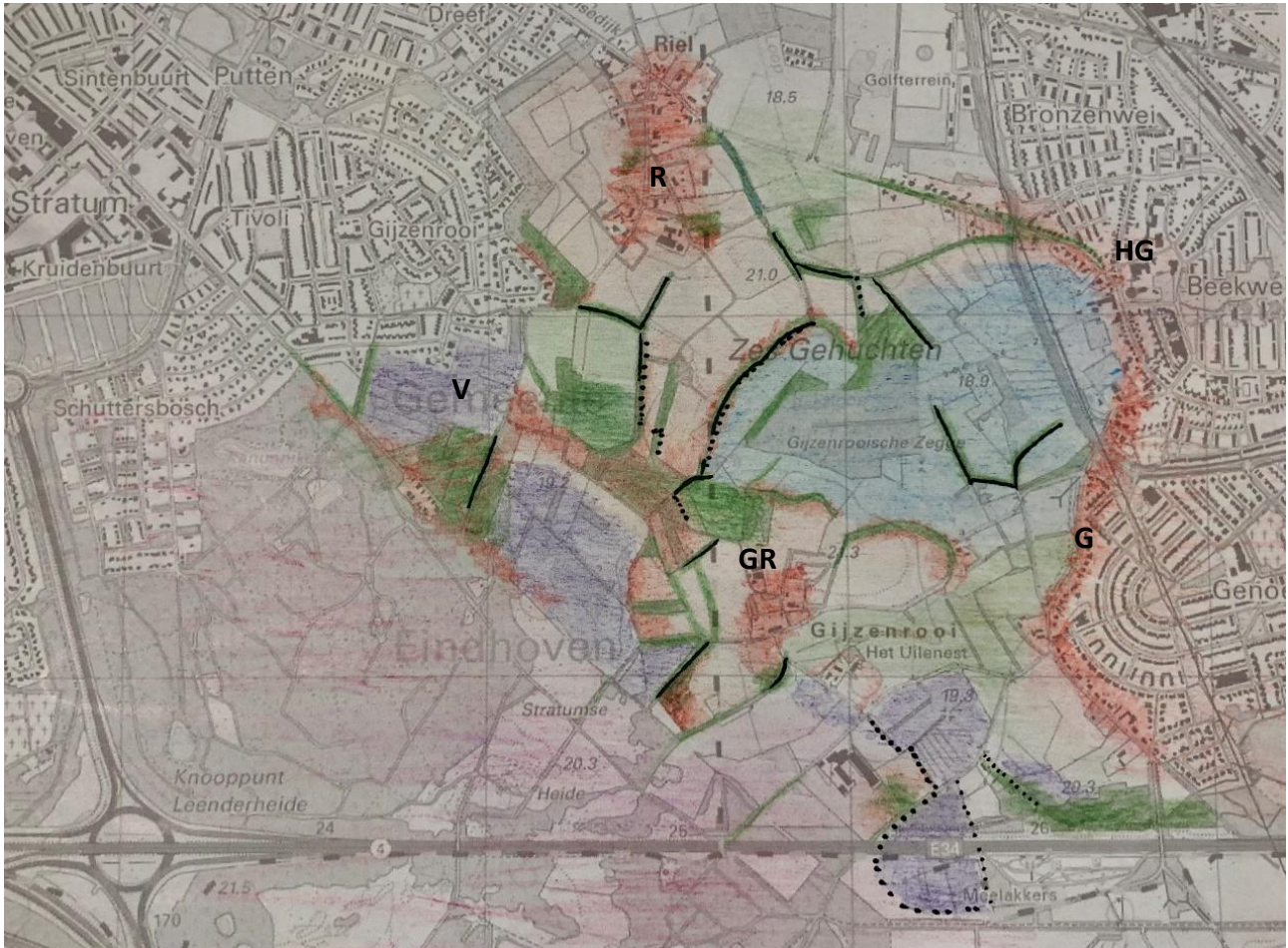
Figuur 11 Belangrijkste steilranden (puntjes geven aan waar onderzoek moet worden verricht om te zien of het hier mogelijk kleine breukjes betreft) en watervoerende zandwegen (zwarte lijntjes). Donkergroen de belangrijkste 'bronbossen' en 'watervoerende houtwallen'. Paars de natte heiden en of (voedselarme) ven(n)en. Met rood de preferente plekken waar grondwater uitreedt uit de hoge gronden; veelal 'aan de rand' en soms 'in' akkers en de gehuchten.
