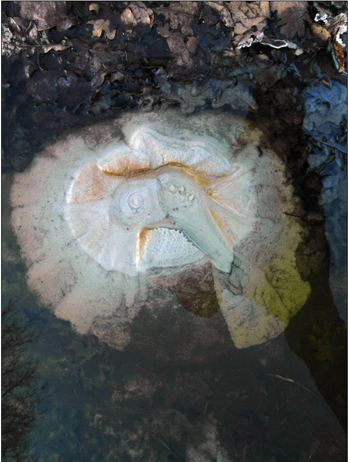
Figuur 65 Kwelkrater van ca. 25 cm met meerdere uitstroomopeningen en uitvloeken van roest (foto: Eric Brinckmann).
