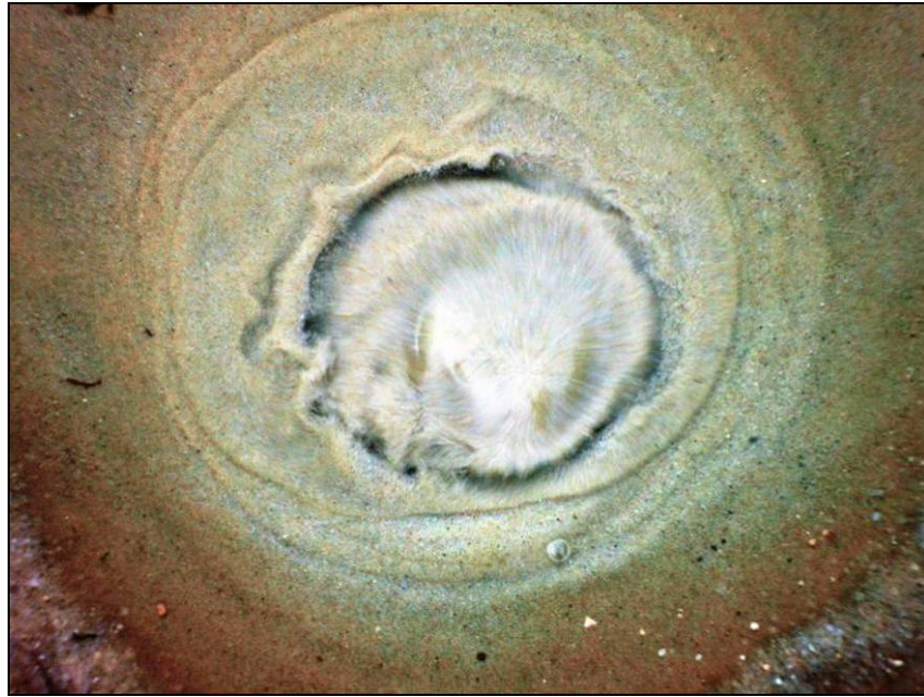
Figuur 67 Kwelkrater door de keileem van ca 10 cm dik heen (foto: Eric Brinckmann).
