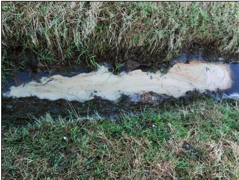
Figuur 63 Kwelkrater met stroomafwaarts een lange staart van verspoeld zand.(foto: Eric Brinckmann).
