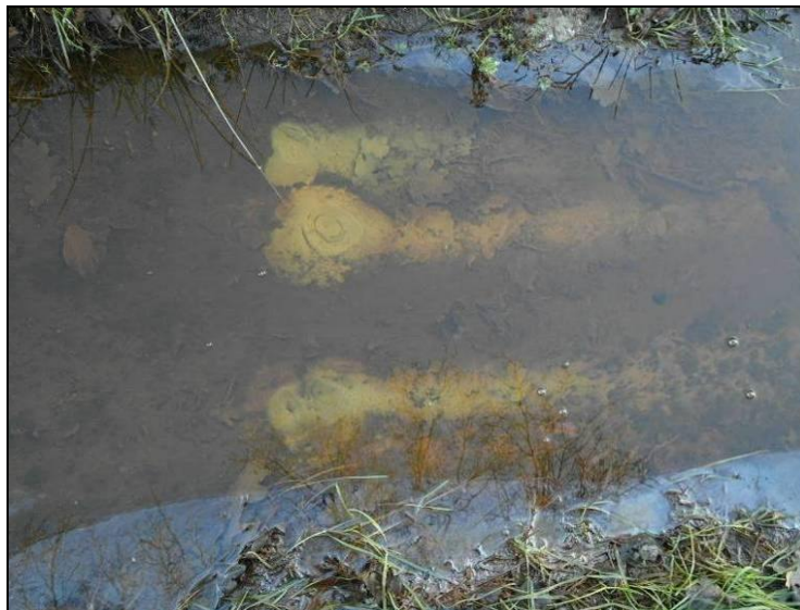
Figuur 64 Drie kwelkraters op rij met verspoeld zand en in het water, wellicht uit naburige percelen. (foto: Eric Brinckmann). Hier zien we twee mechanismen naast elkaar: diepere kwel in het midden met roest door oxidatie van gereduceerd ijzer. Langs de randen oppervlakkig toestromend ijzerrijk water dat benut wordt door ijzerbacteriën.
