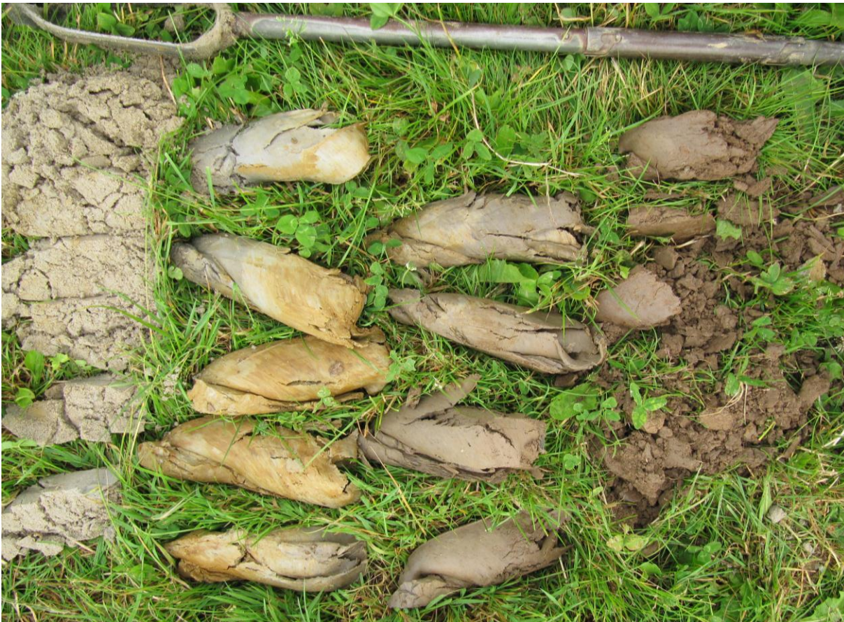
Foto 3 Profiel 7 zware komklei tot 120 cm – mv. op rivierzand (van rechtsonder tot linksboven)
